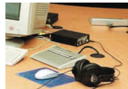
Journalistenarbeitsplatz mit Studer LXB Tastensatz für die Abhörwahl
